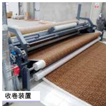
带有铝膜包装器的收卷装置
