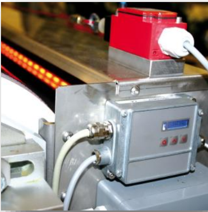
热熔胶装置，配有红外加热器及温控，用以调整打印倒带粘附力
