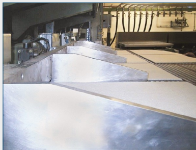
图为方块毯定位装置，便于印花的精确对准
