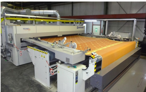
图为烘箱入口处的拉幅定型
