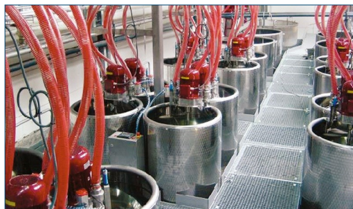
图为 配浆站, 带有自动计量增稠剂及水的计量仪
