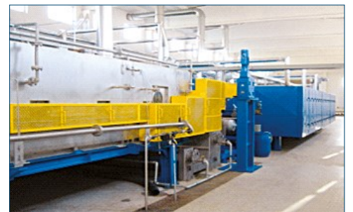
图为水平式蒸箱、清洗装置及烘箱
