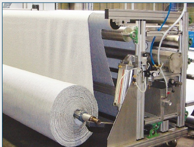
图为退卷装置，配有预蒸，对边及拉辊牵引
