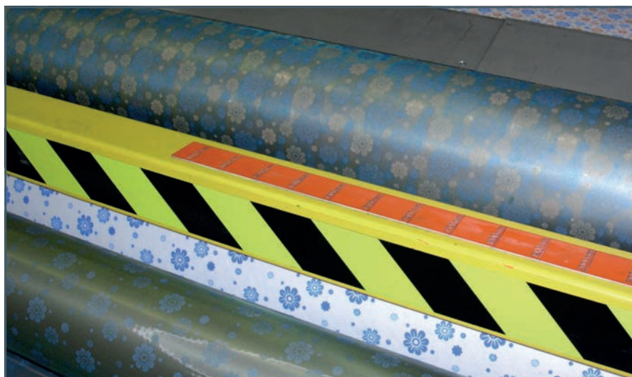
Enduction et impression avec deux pochoirs rotatifs
