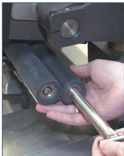
Échanger les arbres cannelés
